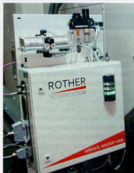
Bild 2: ATS lässt sich mit geringem Adaptionaufwand und ohne nennenswerte Störung der Produktion in Bearbeitungszentren, Transferstraßen sowie Dreh-, Fräs- und Bohrmaschinen aller Hersteller schnell nachrüsten
