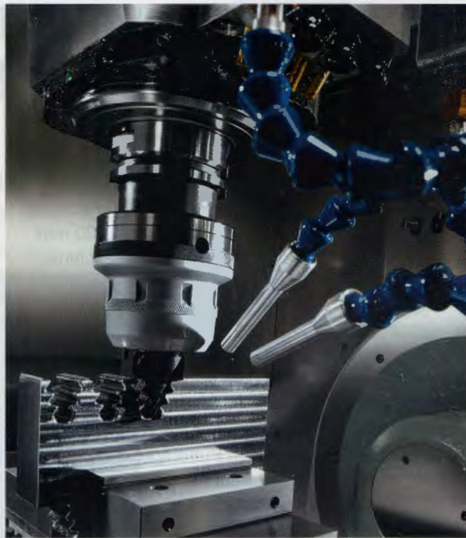
Bild 3: Im Zerspangprozess von Superlegierungen, hochwärmfesten Stählen, Titan und ähnlichen High-Tech-Materialien schlummert enormes Optimierungspotenzial. Insbesondere durch neue Kühlschmierstrategien und -verfahren können Hersteller noch deutlich Kosten einsparen (Werkbilder: Rother Technologie GmbH & Co. KG, Bad Urach)
