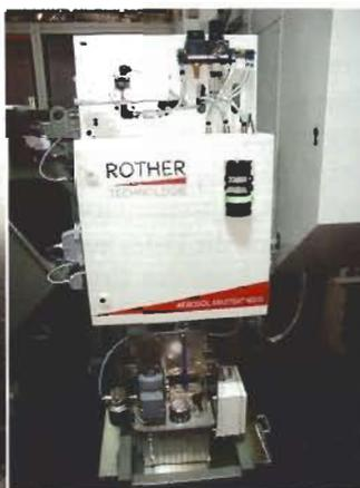
Die Aerosol-Trockenschmierung ATS von Rother Technologie erhöht in vielen Applikationen der industriellen Zerspanspannung deutlich die Produktivität und senkt die Kosten.
