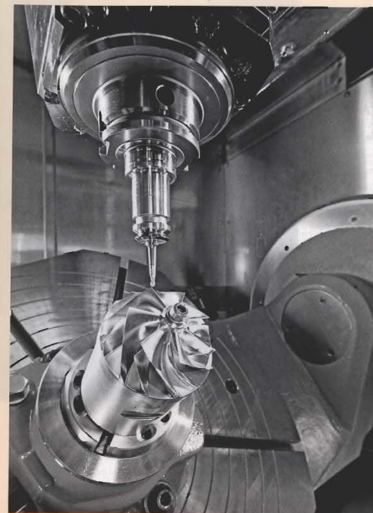
Die kryogene Kühlschmierstrategie »ATS Cryolub« von Rother Technologie reizt in Kombination mit speziellen kryotauglichen Werkzeugen sowie angepassten Bearbeitungsverfahren Maschinen- und Toolperformance aus.
