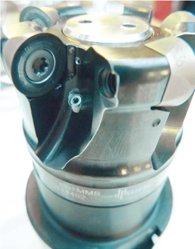
Das eingesetzte Cryotec-Werkzeug von Walter verfügt über optimierte Kühlkanäle bis zur Austrittsbohrung. Auch die Werkzeuggeometrie ist für den Transport von Aerosol und Gas von der Spindel durch den Halter bis ins Werkzeug optimiert. Walter setzt auf die Wendeschneidplatten ROHX1204M0-F67 der Sorte W3536.
