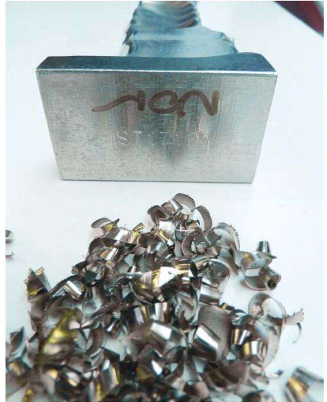
Das Schruppen der Turbinenschaufeln hinterließ trockene, kurze Späne. Das Kryosystem von Rother Technologie hielt sogar die Werkzeugtemperatur auf präzisionsfördernden 40°C.
