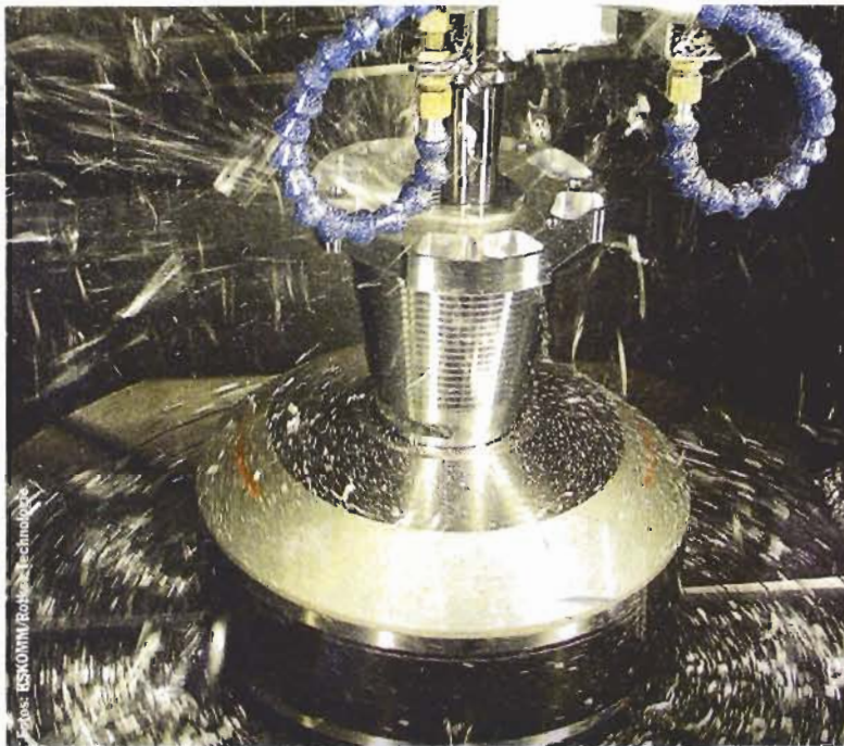
Bearbeitung eines Getriebegehäuses aus Aluminium mit verschiedenen Werkzeugen. Der Einsatz von Kühlschmierstoffen ist dabei ein wichtiger Faktor
