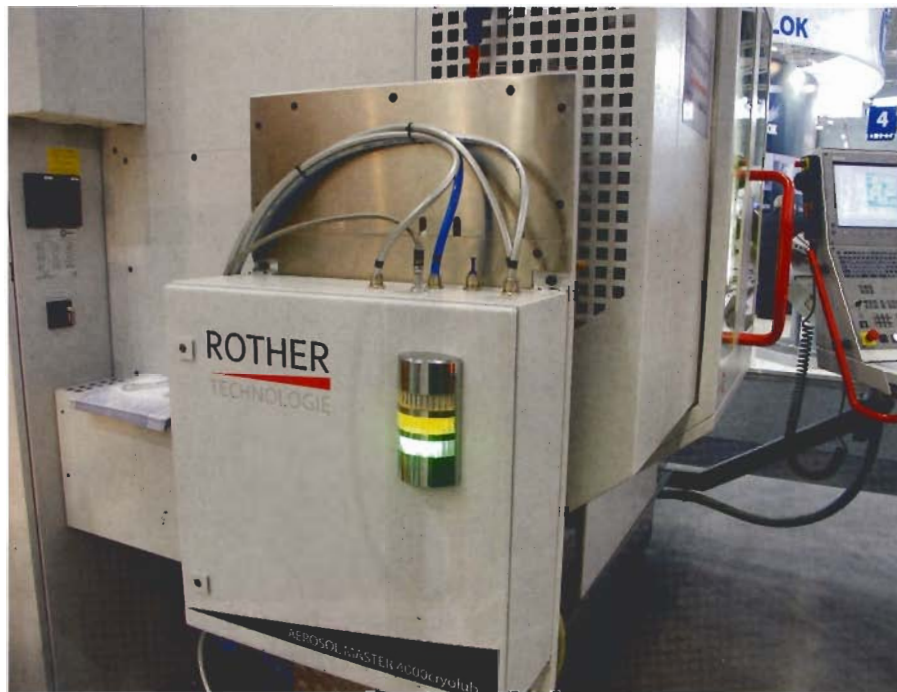
Via High-Speed-Zerspanung auf der Hermle C30 U demonstrierte Emuge Franken während der EMO 2013 unter Einsatz von Hochleistungswerkzeugen und Rother ATS die Herstellung eines Getriebegehäuses aus Aluminium.
